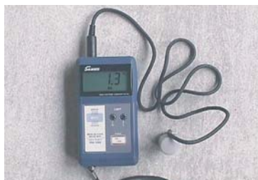
下地調整・含水率測定・外R面取り (写真:直流電気抵抗式モルタル水分計)
