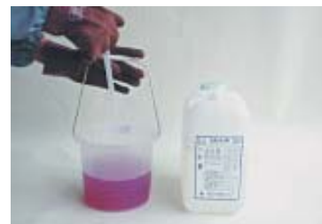
ポリキュートPC-640FXTに 硬化剤混合攪拌
