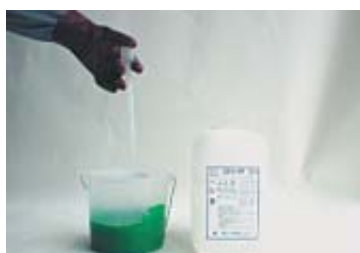
防水トップコートPC-855TPに 硬化剤混合攪拌
