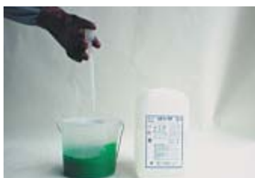
着色ポリキュートPC-640FXTに 硬化剤混合攪拌
