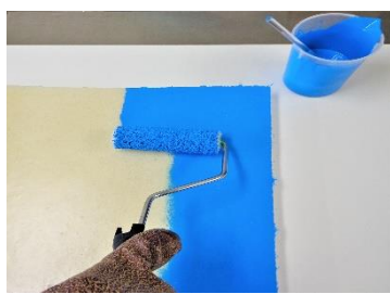
ゲルコートトップ PC-815TP NPG708 を塗布 ※硬化剤使用
